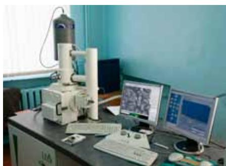
Растровый электронный микроскоп LEO-1430VP (Carl Zeiss, Германия) с системой энергодисперсионного микроанализа INCA Energy 350 (Oxford Instruments, Великобритания).
