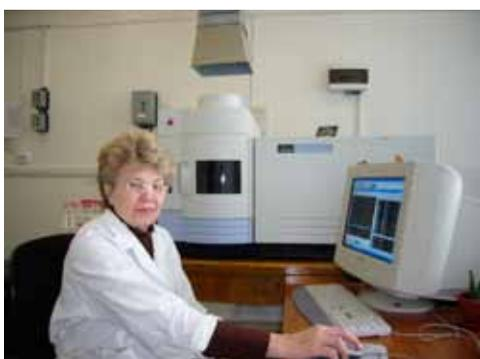
Программное обеспечение **WinLab 32** осуществляет полный контроль спектрометра, обеспечивает полную автоматизацию измерений и управление системой для ввода проб, сохраняет результаты измерений и дает возможность повторной обработки информации без проведения дополнительных измерений.
