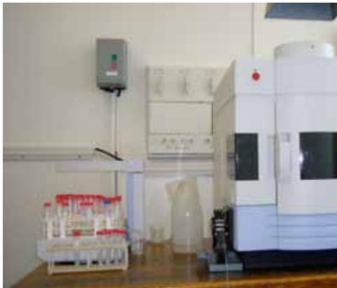
Для автоматизации процесса ввода проб приобретена приставка **Autosampler AS 93 plus** (автодозатор), которая позволяет полностью автоматизировать процесс ввода пробы в плазму, промывку всей системы ввода.
