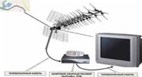
Прием телевизионных и радиоканалов, транслируемых по цифровым наземным эфирным сетям, можно осуществлять при наличии индивидуальной или коллективной антенны и приемного устройства — телевизора со встроенным цифровым ресивером, либо обычного аналогового телевизора с приставкой — цифровым эфирным ресивером.
