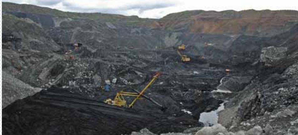
с емкостью ковша 41 м<sup>3</sup> и годовой производительностью каждого до 12 млн. м<sup>3</sup>, восемнадцать автосамосвалов БелАЗ с грузоподъемностью 220 тонн, буровые станки ДМ-М2, Pit Viper. Большие финансовые вложения компания направила на строительство и запуск Тугнуйской обогатительной фабрики.
